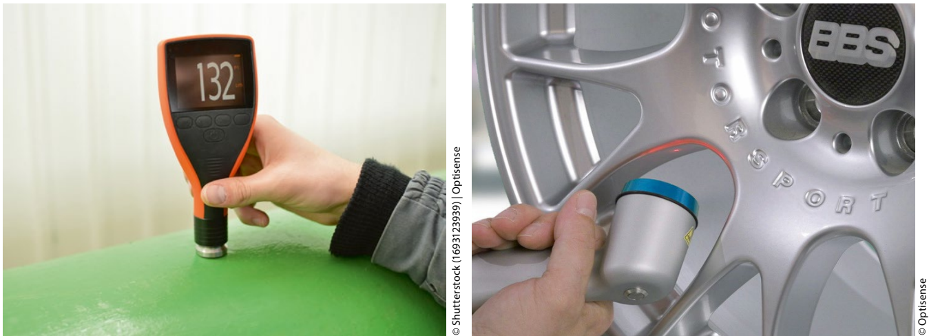
Bild 2 > Messung mit Wirbelstromtechnik (links) und Photothermieverfahren (rechts)
